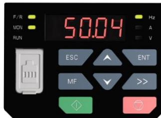
Рис. 4-7. Режим прямого изменения частоты
