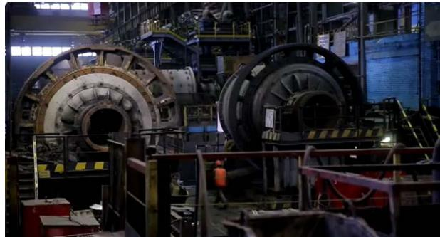
Модернизация оборудования и технологических процессов дала ряд положительных эффектов. Производство практически полностью автоматизировано. За счет сокращения внеплановых простоев увеличилась производительность. Заметно вырос уровень энергоэффективности. Применение частотно-регулируемых приводов и устройств плавного пуска также ведет к увеличению срок службы электрооборудования.
