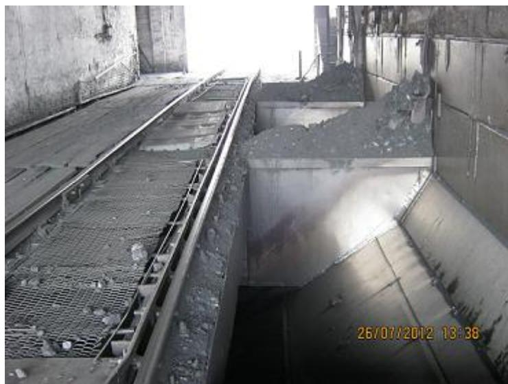
В рамках ремонта и модернизации обогатительной фабрики предприятия, производилась модернизация приводов питателей. В приводах использовался многоскоростной двигатель. Устаревшее оборудование не позволяло оптимально настроить технологический процесс. Требовалась плавная регулировка скорости работы питателя, с помощью стоявшего оборудования это было не возможно осуществить.
